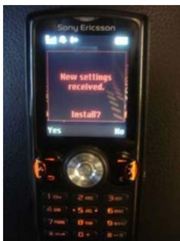
Figura 4. Recepción de una nueva configuración a través de OTA [Ref.- 24].
